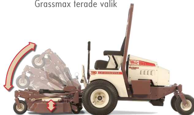
Elektriline PowerFold® kõrguse reguleerimine ja hooldusasendisse tõstmine standardvarustuses.
